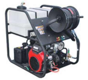
Háþrýstibúnaður fyrir stíflulosun í skolp og drenörum. Getum útvegað þennan búnað í mörgum útfærslum og styrkleikum. Fyrir rör frá 30 mm upp í 900 mm. Háþrýstislöngur allt að 150 metrar á lengd, 3/8", 1/2", 5/8", 3/4". Bensín / dísil, vatnsflæði allt að: 132 L / min @ 3000 Psi. Búnaður á sérsmíðuðum vagni með þrýstibremsum eða á stálgrind. Búnaðurinn hentar einnig vel fyrir öflugan háþrýstipvott. Vandaður og hentugur búnaður, fyrir sveitarfélög og verkataka. Hákonarson ehf. Uppl. í síma 892-4163, hak@hak.is, www.hak.is
