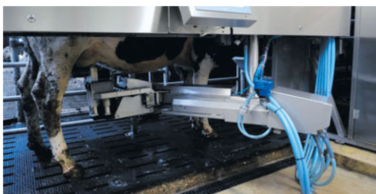
Merlin mjaltapjóninn er sagður frábrugðinn öllum öðrum mjaltapjónum á markaðinum í hönnun vegna þess að hann er með lægsta arminn. Það geti skipt miklu máli eins og fyrir lágvaxnar íslenskar kúr og síðjúgra sem í mörgum tilvikum þurfa að fara upp á kubba til að láta mjaltapjóna mjólka sig.
