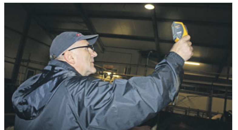
Guðmundur er með þar til gerða hitamyndavél og kannar með henni ástand á raftækjum og lögnum.
