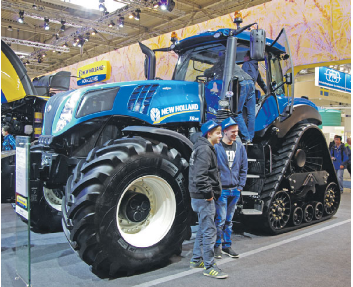
Auk flaggskipsins T7.315 sýndi New Holland þennan fjallmyndarlega T8 með belti að aftan sem eykur flothæfni dráttarvélarinnar á gljúpu landi.
