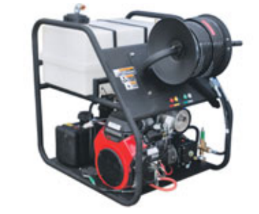
Háþrýstibúnaður fyrir stíflulosun í skolp og drenörum. Getum útvegað þennan búnað í mörgum útfærslum og styrkleikum. Fyrir rör frá 30 mm upp í 900 mm. Háþrýstilöngur allt að 150 metrar á lengd, 3/8", 1/2", 5/8", 3/4". Bensín / dísel, vatnsflæði allt að: 132 L / min @ 3000 Psi. Búnaður á sérsmíðuðum vagni með þrýstibremsum eða á stálgrind. Búnaðurinn hentar einnig vel fyrir öflugan háþrýstipvott. Vandaður og hentugur búnaður, fyrir sveitafélög og verktaka. Hákonarson ehf. Uppl. í síma 892-4163, hak@hak.is, www.hak.is
