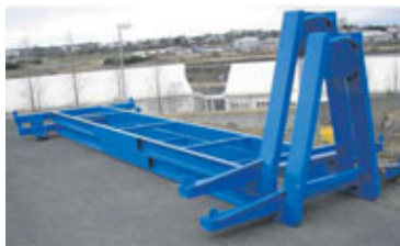
Framleiðum krókheysisgrindur með eða án gámalása. Grunnaðar og/eða málaðar. Gott verð. Vagnasmidjan. is - Eldshöfða 21 Rvk. Uppl. í símu 898-4500 og 894-6000.
