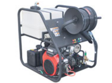
Háprýstibúnaður fyrir stíflulosun í skolp og drenrörum. Getum útvegað pennan búnað í mörgum útfærslum og styrkleikum. Fyrir rör frá 30 mm upp í 900 mm. Háprýstilöngur allt að 150 metrar á lengd, 3/8", 1/2", 5/8", 3/4". Bensín / diesel, vatnsflæði allt að: 132 L / min @ 3000 Psi. Búnaður á sérsmíðuðum vagni með þrýstibremsum eða á stálgrind. Búnaðurinn hentar einnig vel fyrir öflugan háprýstipvott. Vandaður og hentugur búnaður, fyrir sveitafélög og verktaka. Hákonarson ehf. Uppl. í síma 892-4163, hak@hak.is, www.hak.is
