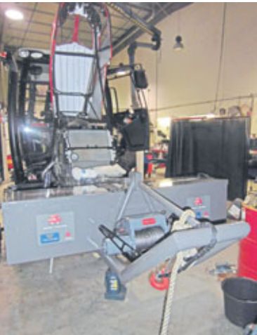
Sprunguvarnargrind og öflugt spil var sett á Massey Fergusoninn.
