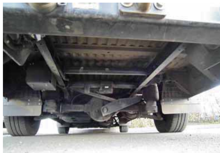
Grindin sem bíllinn er byggður á nær alla leið aftur í stuðara.
