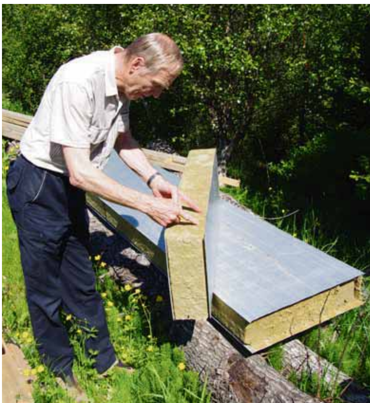
Guðmundur með sýnishorn af steinullareiningum og sýnir hvernig styrkleikinn var aukinn með því að leggja steinullina á ákveðinn hátt í samlokuna.
