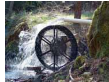
Einfalt vatnshjól með yfirrennslis.
