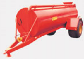
Miðflótttaafisdæludreifari Fyrir kúamykju. Léttbyggður á flotdekkjum.
