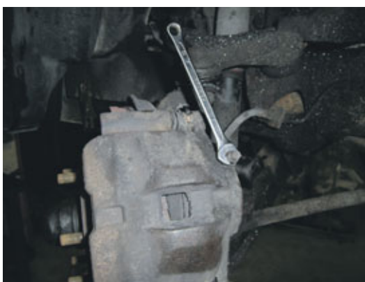
Á sumum bílum er gott að komast að lofttappanum og þarf ekki að taka dekk af.
