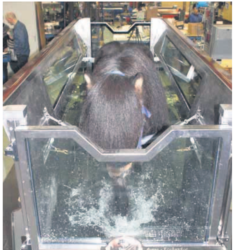
Vatnshlaupabretti fyrir stóra hesta, sem var selt til Landbúnaðarháskóla í Bretlandi. Brettin eru úr ryðfriú stáli og mjög gott að þrifa og viðhalda þeim.
