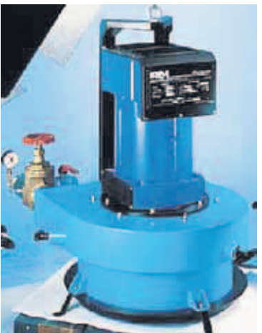
Minna gerðin af IREM Pelton TPS024-vatnsaflstúrbínum, sem er einfasa 230 volta og 50 ríð. Stærri túrbínurnar af sömu gerð gefa 230/400 volt.
