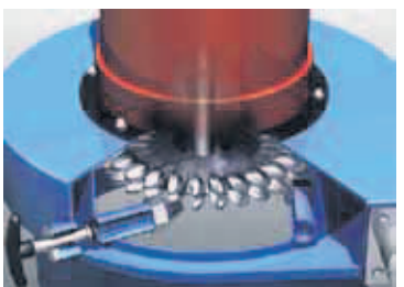
Hér sést innvolsið í IREM Pelton-túrbínunni, en spissar sprauta vatninu undir þrýstingi á skófluhjólið.
