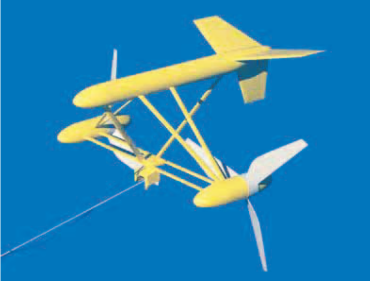
Golfstraumstúrbínan var hugsuð til að virkja sjávarstrauma úti fyrir strönd Suður-Flórída en gæti örugglega nýst í öflugum sjávarfallastrumum eins og í Breiðafirði. Hún er sögð afar orkunýtin.
