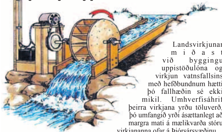
Einföld útgáfa af virkjun með undirrennslisgjóli.
