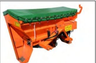
Salt- og sanddreifari HZS-10, 1m 3 , glussadrifin, með klumpabryjt og tjakk Verð: 1.370.000 kr. + vsk
