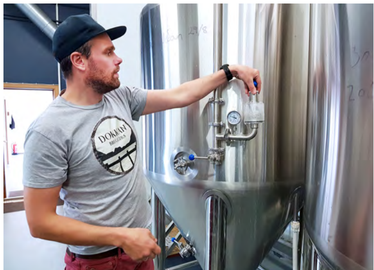
Dokkubjórinn er látinn gerjast í tönkunum undir þrýstingi og þá samlagast náttúrulega kolsýran sem myndast bjórnum betur en kolsýra sem hleypt er á hann eftir á.
