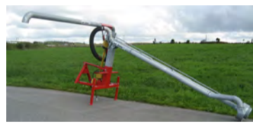
Norskar skádælur. 5" eða 6" dælurör, 4,3 m eða lengra. Dælugeta, frá 8.000 l/mín. Hræristútur sem hægt er að snúa 360° og skurðarblöð á dæluhjól. Þarf op sem er 70 x 70 cm. Hákonarson ehf. hak@hak.is, s. 892-4163.
