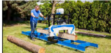
Stórviðarsög á braut. Aflgjafar: Kohler bensínmótorar eða rafmótorar. Lengd á braut: 3,8 m, hægt að lengja um 1,52 m eða meira. Mesta þykkt á trjábol: 66 cm. Framleiðandi, Timbery í Póllandi. CE merktur og vottaður búnaður. Hentar í alla stórviðarsögun. Hákonarson ehf. S. 892-4163, netfang: hak@hak.is
