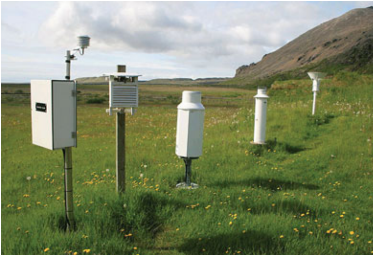
Kvísker í Öræfum. Hér sjást þrjár tegundir úrkomumæla: hefðbundinn, gamall úrkomusíriti og afbrigðilegur sjálfvirkur vigtarmælir. Myndin er tekin 2. júlí 2009.
