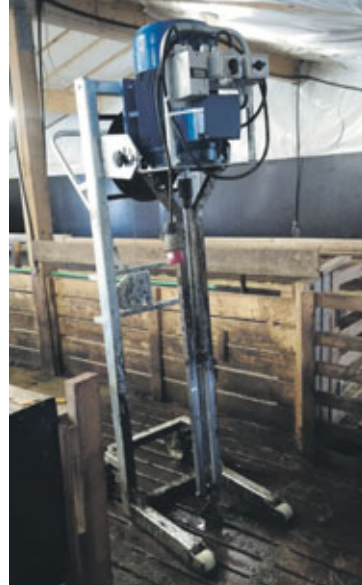
Innihætur fyrir gripahús. Rafdrifnar : 7,5 KW, 9,2 KW, 11 KW Glussadrifnar : 8 KW, 60 L / min, 120 Bar.Vinnudýpt : 130 cm Skrúfa : 200 mm. Hákonarson ehf. Uppl. í síma 892-4163, hak@hak.is,www.hak.is
