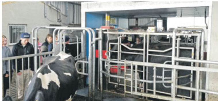
Mjaltapjóninn frá SAC er all frábregður þeim mjaltapjónum sem við þekkjum hér á landi enda sér sérstakur tölvustýrður armur um að þjónusta tvo mjaltaklefa og því geta tvær kýr verið mjólkaðar í einu með einum mjaltapjóni.
