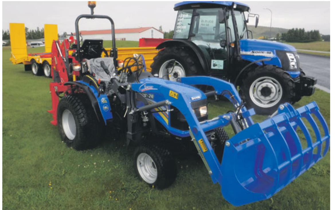
Litla vélin hlaðin tækjum, á grasdekkjum, með moksturstæki og aflúrtakstengt grófubakkó.
