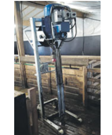
Innihærur fyrir gripahús. Rafdrifnar: 7,5 kw, 9,2 kw, 11 kw glussadrifnar: 8 kw, 60 l / min., 120 bar. Vinnudýpt: 130 cm skrúfa : 200 mm. Hákonarson ehf. Uppl. í síma 892-4163, hak@hak.is, www.hak.is.
