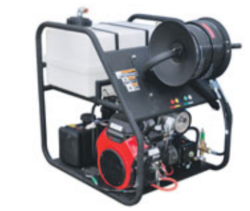
Háprýstibúnaður fyrir stíflulosun í skolp og drenörum. Getum útvegað þennan búnað í mörgum útfærslum og styrkleikum. Fyrir rör frá 30 mm upp í 900 mm. Háprýstislöngur allt að 150 metrar á lengd, 3/8", 1/2", 5/8", 3/4". Bensín / dísil, vatnsflæði allt að: 132 l / min @ 3000 Psi. Búnaður á sérsmíðuðum vagni með þrýstibremsum eða á stálgrind. Búnaðurinn hentar einnig vel fyrir öflugan háprýstipvott. Vandaður og hentugur búnaður fyrir sveitafélög og verktaka. Hákonarson ehf. Uppl. í síma 892-4163, hak@hak.is, www.hak.is.
