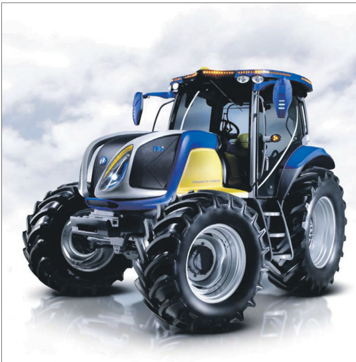
New Holland NH 2 vetnisknúna dráttarvélin er byggð á grunni New Holland T6000 vélarinnar rétt eins og metangasknúna vélina frá fyrirtækinu.
