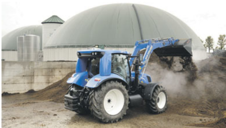
Þessi New Holland T6.180 dráttarvél gengur fyrir metangasi.
