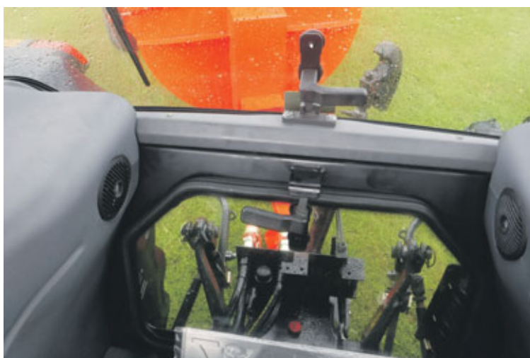
Úr sætinu á 75 hestafla vélinni sést vel niður á þritengibúnaðinn út um neðri afturgluggann úr ökumannssætinu.
