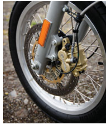
Brembo bremsur og samskonar ABS-kerfi og er í BMW.
