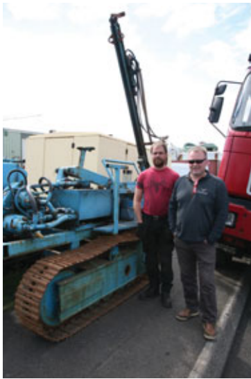
Minnsti bor þeirra feðga er að hluta til settur saman úr ólíkum tækjabúnaði inni á smíðaverkstæði Vatnsborunar. Mynd / TB
