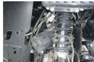
520 hjólið er með rafmagnsstýribúnað sem léttir stýringu.
