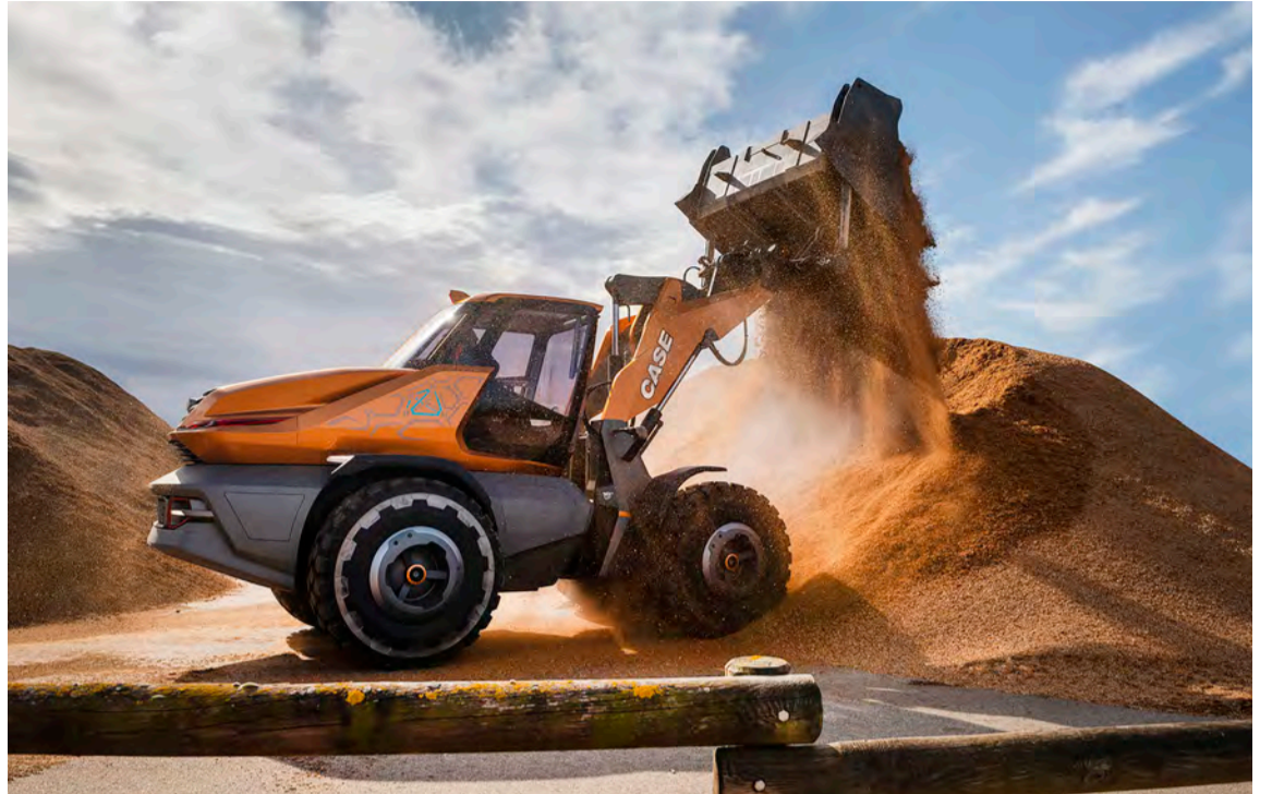
CASE Tetra hjólaskófla er með 6 strokka NEF gasmotor [náttúrugas – NG] frá FPT industrial.
