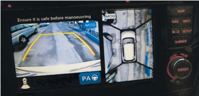
Bakkmyndavélin til vinstri og 360 gráðu myndin til hægri þegar bakkað er í stæði.
