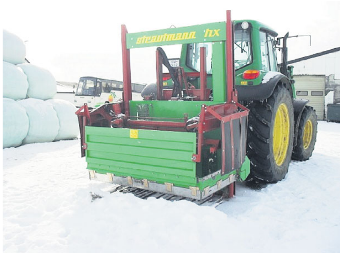
Til að koma í veg fyrir hitamyndun í votheysstæðum þegar fóður er sótt er happadryggt að stálið sé sem sléttast. Kropp og klór með bitlausum verkfærum hleypir súrefni inn í stæðuna.
