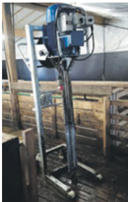
Innihæruer fyrir gripahús. Rafdrifnar: 7,5 KW, 9,2 KW, 11 KW glussa-drifnar : 8 KW, 60 L / min, 120 Bar. Vinnudýpt : 130 cm Skrúfa : 200 mm. Hákonarson ehf. Uppl. í síma 892-4163, hak@hak.is, www.hak.is
