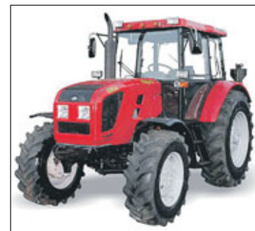
Belarus 920, árgærd 2011, fyrsta rafknúna dráttarvélin sem framleidd er í Hvíta-Rússlandi. Hún er með 60 kílówatta og 300 volta mótör sem skilar 250 Newtonmetra tugi. Orkan er geymd á líthíum-rafhlöðum sem dugar í í notkun í 3–4 tíma.
