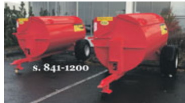
Keðjudreifari 4,5m3 (4500 lítra). Aflþörf 45Hp. Breið vagndekk stærð 400/60-15,5. Driftskaft fylgir með. Verð 980.000 kr án vsk. Uppl. í síma 841-1200.
