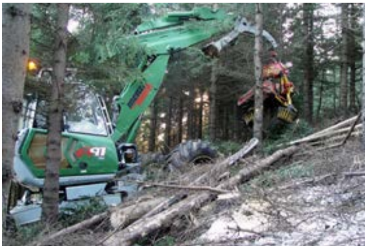
Græni drekkinn, Menzi Muck A91 4x4 plus, að vinna við brattar aðstæður. Þetta var fyrsta vélin sem talist getur sérhæfð skógarhöggsvél og var flutt inn í október 2006. Í kjölfar efnahagshrunsins 2008 var stórlega skorið niður í skógrækt og urðu verkefni fyrir „Græna drekkann“ fá eftir það. Eigandinn, Guðjón Helgi Ólafsson, neyddist því til að selja vélinu úr landi í október 2009.
