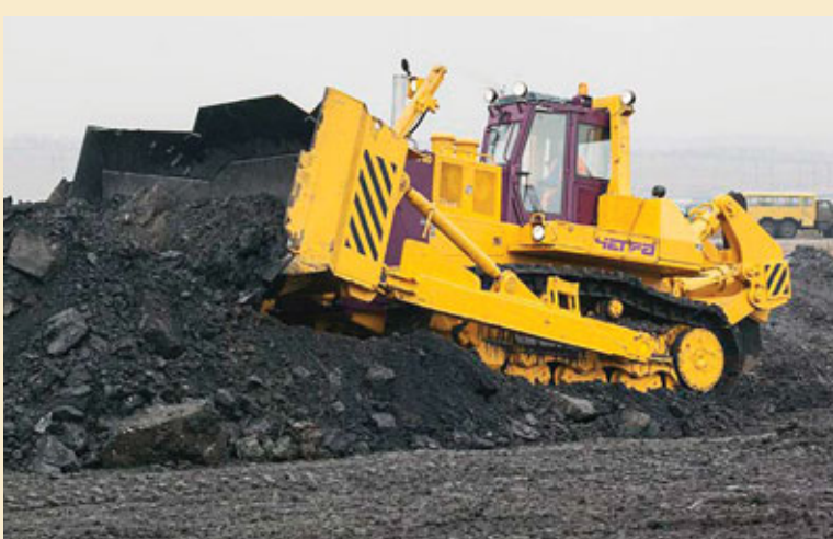
Chetra T40 er stærsta jarðytan sem framleidd er í Rússlandi og er tæp 65 tonn að þyngd.
