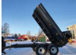
6 mm hardox í botni og 5 mm hardox í hlöðum. Dekk 520/50-17. Verð kr. 2.290.000 án vsk. Með 40 mm auga. Fáanlegur með kúlutengi. Búvís ehf. Sími 465-1332.
