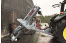
Traktor-drifnar brunndælur með mikla hrærigetu. Margar stærðir og útfærslur fyrir bændur og verkta. Dælugeta allt að 27.300 L/mín. Stuttur afgreiðslutími. Hákonarson ehf. S. 892-4163, hak@hak.is - www.hak.is
