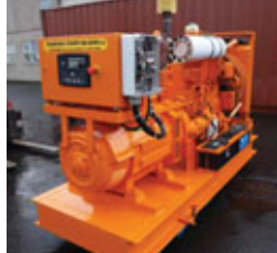
Til sölu Volvo rafstöð 80 kW/100 kva, 400/230 V, 50 Hz, 160 A. Rafstöðin er keyrð aðeins 165 kst. Ný DSE AMF/ATS stjórntölva, Stamford rafall, Woodward rafenda gangráður, 200 ltr oliutankur í undirstöðu, nýlegir rafgeymar, hljóðkútur og þúströr fylgja með. Vandlega yfirfarin og snyrtileg vél. Verð kr. 1.200.000 án vsk. Uppl. í síma 775-7334.
