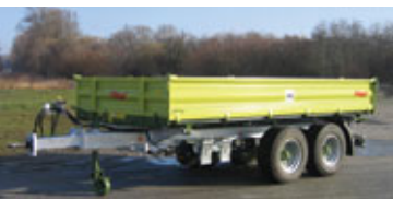
Fligel TDK 110-88 Pallur er 450x222cm Galvaníseruð grind. Sturtur á þrjá vegu, öll ljós eru á henni til skráningar, breið burðardekk 355/60 R18 16 PR. Verð 2.400.000 + vsk.
