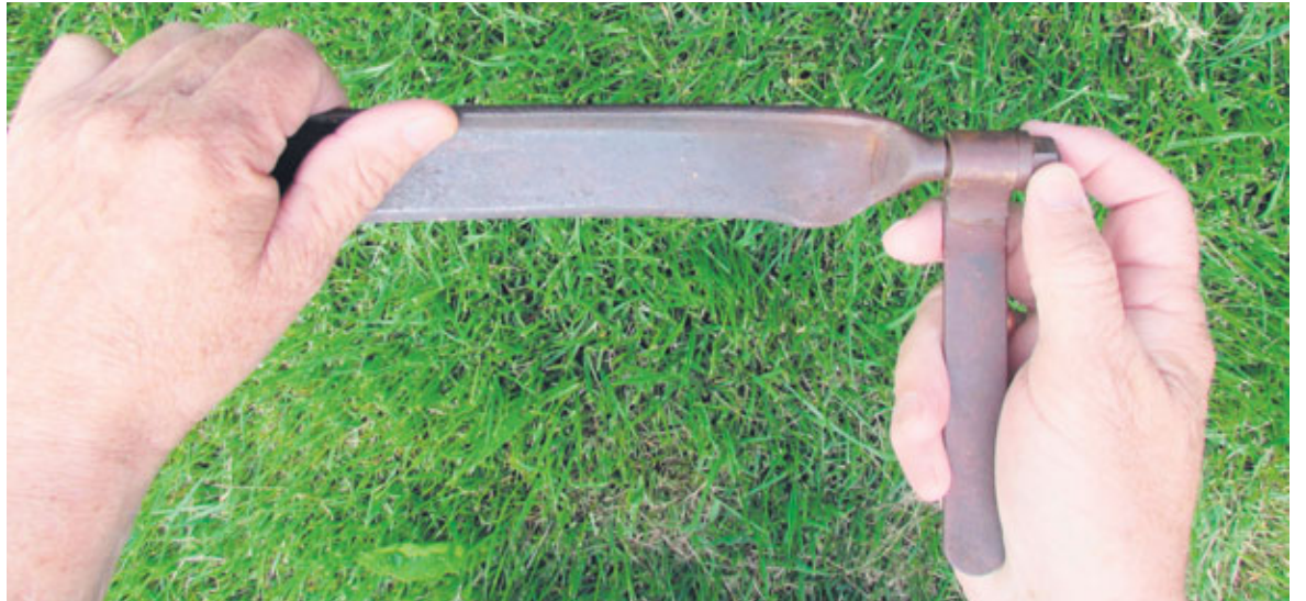
Skrúfuþjósljár Torfa gerður eftir lýsingu í hinu breska einkaleyfi nr. 1499. Uppfinningin lét ekki mikið yfir sér. Jóhannes Ellertsson vélsmiður útbjó ljáinn fyrir Landbúnaðarsafn Íslands.
