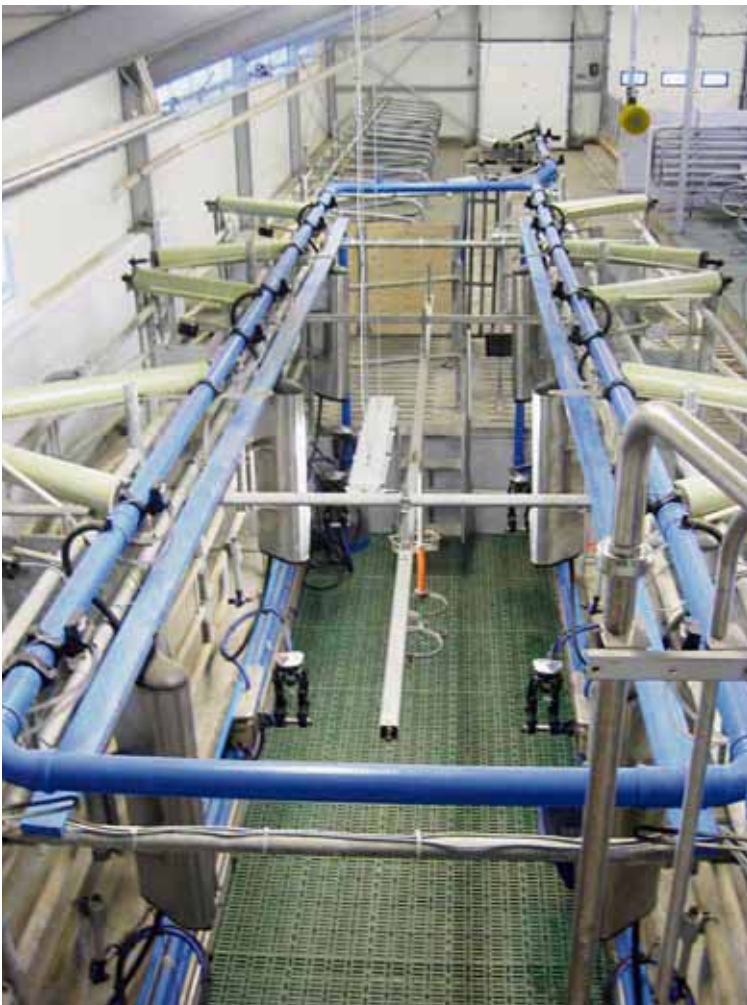
Séð yfir mjaltabásinn, sem er búinn sex mjaltatækjum af tegundinni Alfa-Laval Tandrum.
