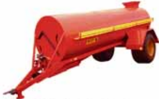
Snekkjudæludreifari Fyrir fjárhúskjallara, lausagöngu og kúamykju. Hrærir upp í haughúsum, tekur upp í sig og dreifir mjög vel.
